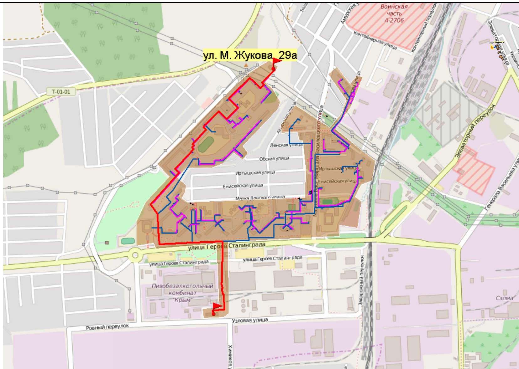
Рисунок 170 – Путь для построения пьезометрического графика от котельной по ул. Узловая, 9 до потребителя по ул. М. Жукова, 29а
